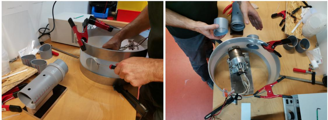
Abbildung 14: Loch schmelzen und Flansch anschweißen
