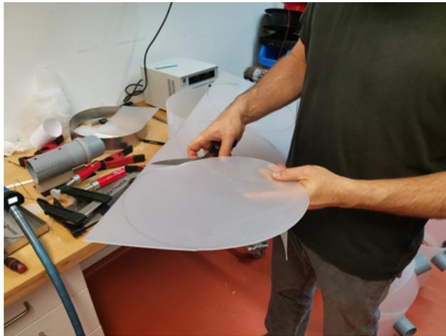
Abbildung 15: Scheibe als Abschluss ausschneiden und später anschweißen
