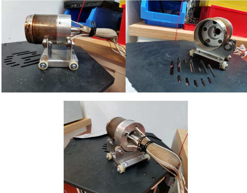
Abbildung 11: Verteiler-Schweißgerät (Spezialwerkzeug selbstgefertigt)
