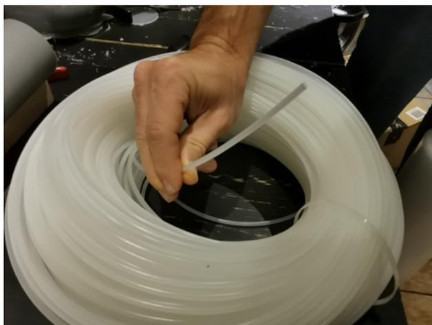
Abbildung 21: Schweißdraht für Verteiler
