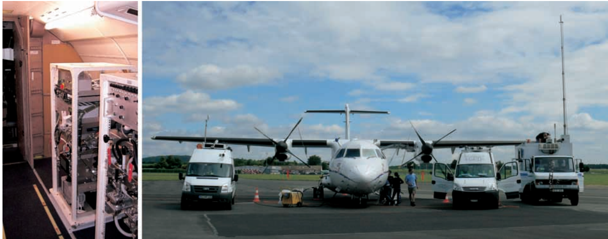
Abb. 2: Einzelpartikel-Aerosolmassenspektrometer im Flugzeug (links). Vergleichsmessung der Messinstrumente an Bord des französischen Forschungsflugzeugs ATR-42 und der verschiedenen an der Messkampagne beteiligten Messfahrzeuge. Links, das Mobile Labor (MoLa) der Partikelchemie (rechts).
