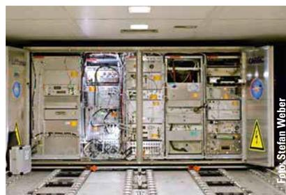
*Lieferte Langzeitdaten: Der CARIBIC-Messcontainer im Laderaum eines Lufthansa-Flugzeugs. | The CARIBIC container onboard a Lufthansa airplane provided long-term measurements.*
