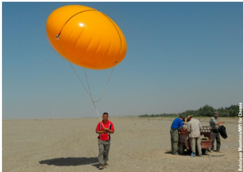
Um die Stickoxid-Mengen zu bestimmen, benötigt man auch meteorologische Daten. Daher ließen die Forscher Wetterballons in der Wüste starten. | In order to determine the amounts of nitrogen oxide, meteorological data are needed. Thus the researchers launched weather ballons in the desert.
