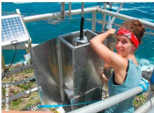
Maria Prass bei Arbeiten am MOUDI-Sampler (größenaufgelöste Sammlung von Aerosolen). | Maria Prass working at the MOUDI-Sampler (size-resolved collection of aerosols).
