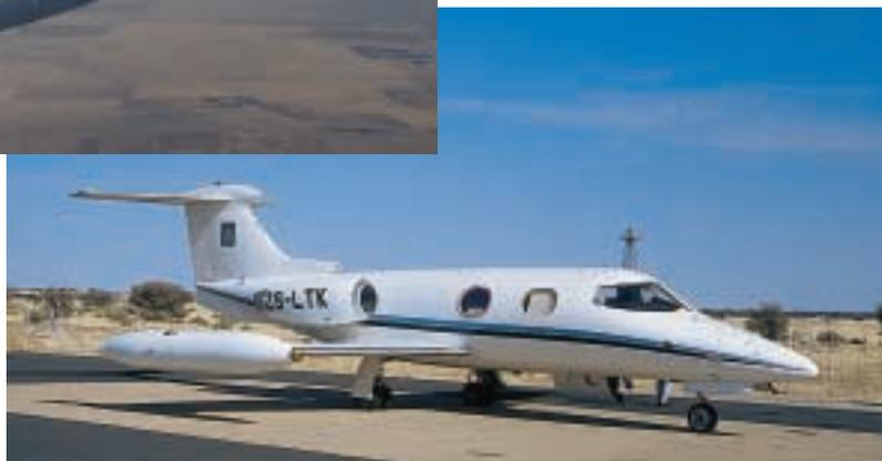
**Abb. 10.** Der graue Horizont zeigt die starke Staubbelastung der Atmosphäre über dem südlichen Afrika. Die Sonde für die Staubmessung hängt im Außen-tank des Messflugzeuges. Hier ist es ein Learjet 24 der Water Commission von Südafrika.
