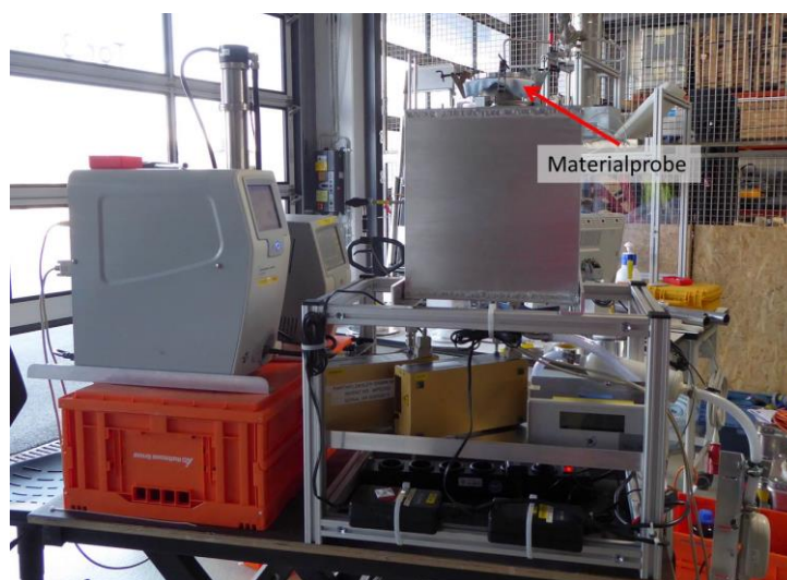
Abb. 2: Schema und Abbildung des Versuchsaufbaus zur Messung von Abscheideeffizienzen von Partikeln im Größenbereich 30 nm bis 10 \mu\text{m} .
