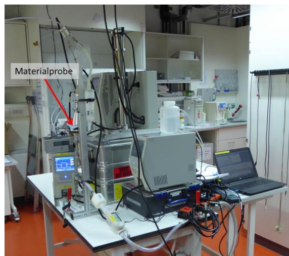
Abb.1: Schema und Abbildung des Versuchsaufbaus zur Messung der Abscheideeffizienz für kleine Partikel
