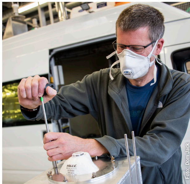
Thomas Böttger baut ein Aerosolmessgerät zum Testen von Community Masken um. | Thomas Böttger modifies an aerosol measuring device to test face masks.
