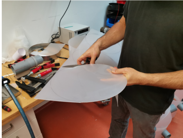
Abbildung 15: Scheibe als Abschluss ausschneiden und später anschweißen
