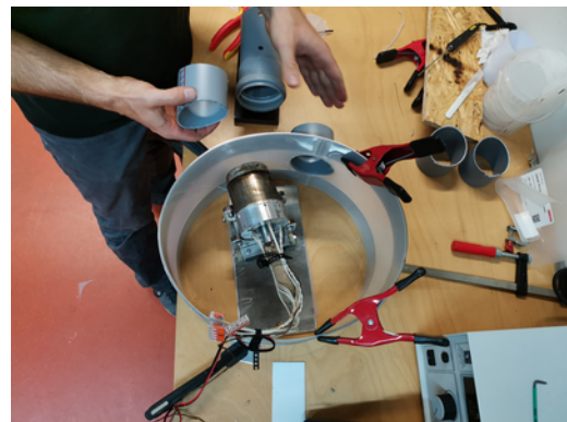
Abbildung 14: Loch schmelzen und Flansch anschweißen
