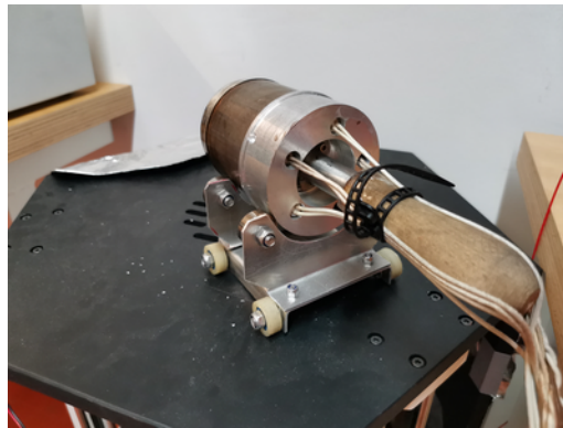
Abbildung 11: Verteiler-Schweißgerät (Spezialwerkzeug selbstgefertigt)
