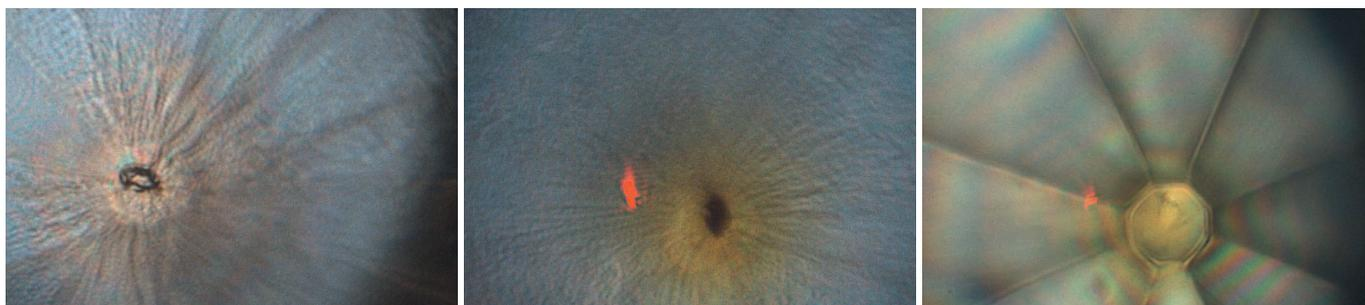
Unscheinbare Flecken mit spektakulärer Bedeutung: Beim Blick durch einen Diamanten in die mit Wasserstoff gefüllte Zelle bleibt deren Inneres durchsichtig, solange der Wasserstoff unterhalb von zwei Millionen Atmosphären gasförmig vorliegt (links). Bei 2,2 Millionen Atmosphären verfärbt sich das Element dunkel, wenn es in den halbleitenden Zustand wechselt (Mitte). Bei 2,7 Millionen Atmosphären nimmt der Wasserstoff schließlich den metallischen Glanz an (rechts).
