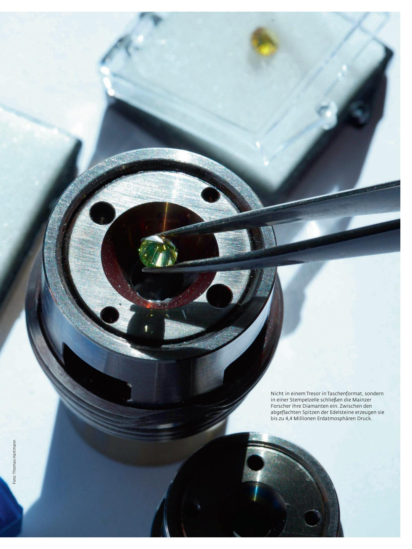
Nicht in einem Tresor in Taschenformat, sondern in einer Stempelzelle schließen die Mainzer Forscher ihre Diamanten ein. Zwischen den abgeflachten Spitzen der Edelsteine erzeugen sie bis zu 4,4 Millionen Erdatmosphären Druck.
