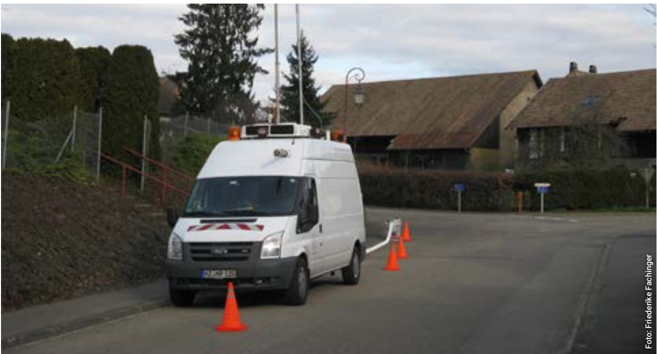
Emissions- und Immissionsmessungen mithilfe des mobilen Aerosolforschungslabors MoLa in der Umgebung von Holzverbrennungsanlagen. Emission and immission measurements using the mobile aerosol research laboratory MoLa in the vicinity of wood combustion plants.
