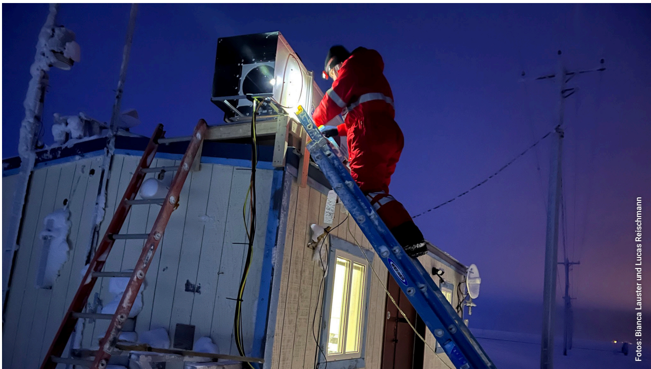
Das Teleskop des LP-DOAS wurde auf der Hütte montiert. Weitere Instrumententeile, bspw. der Detektor, sind in der Hütte untergebracht.
