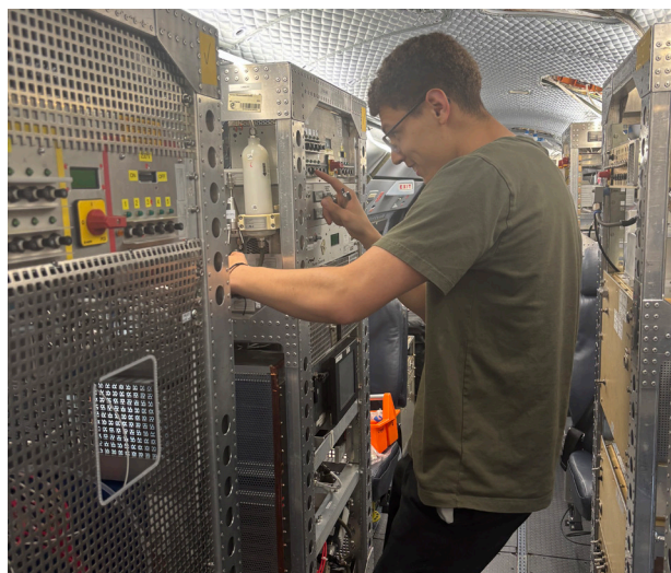
William Schenk montiert die Rohrleitungen für einen Aerosoleinlass, über den bei wolkenfreiem Himmel Aerosolpartikel erfasst werden.
