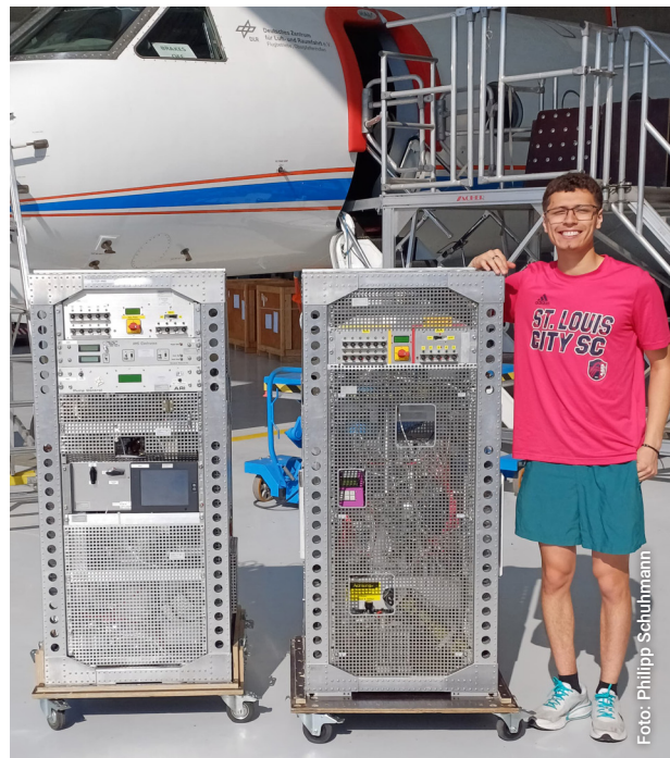
William Schenk übergab in Oberpfaffenhofen bei München diese Aerosol-Massenspektrometer für den Einbau in das Forschungsflugzeug HALO.
