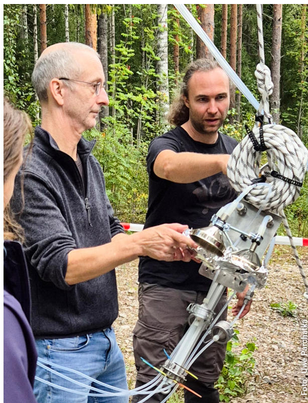
John Crowley (l.) und Jan Schuladen bereiten den Seilzug und den daran befestigten Lufteinlass vor, der stufenweise in die Höhe gezogen wurde. | John Crowley (left) and Jan Schuladen prepare the cable and the air intake attached to it which was gradually pulled up the tower.
