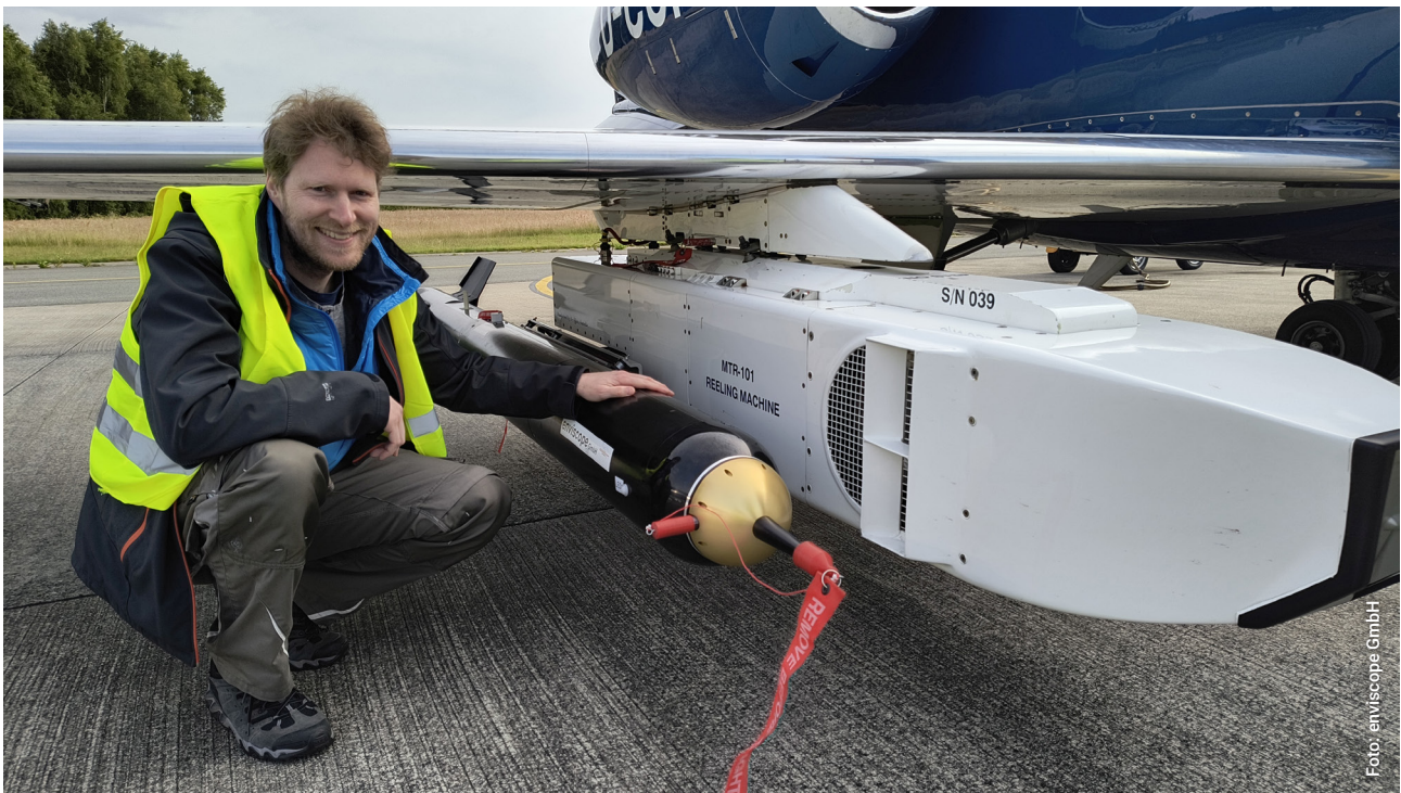
Heiko Bozem (JGU Mainz) neben dem TOSS, der mit einer Winde unterhalb der Tragfläche des Learjet montiert ist.
