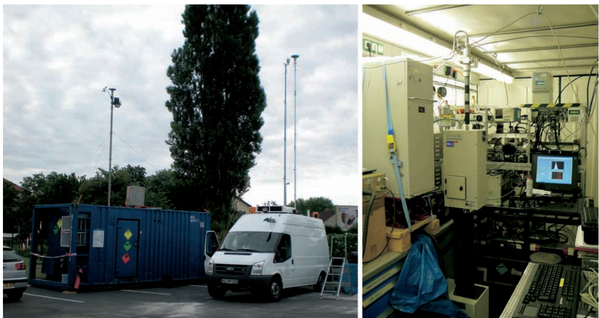
Abb. 1: Messstation im Nordosten von Paris mit Messcontainer und mobilem Aerosolforschungslabor MoLa (links). Moderne Messinstrumente (rechts) erlauben eine umfassende Untersuchung des atmosphärischen Aerosols.
