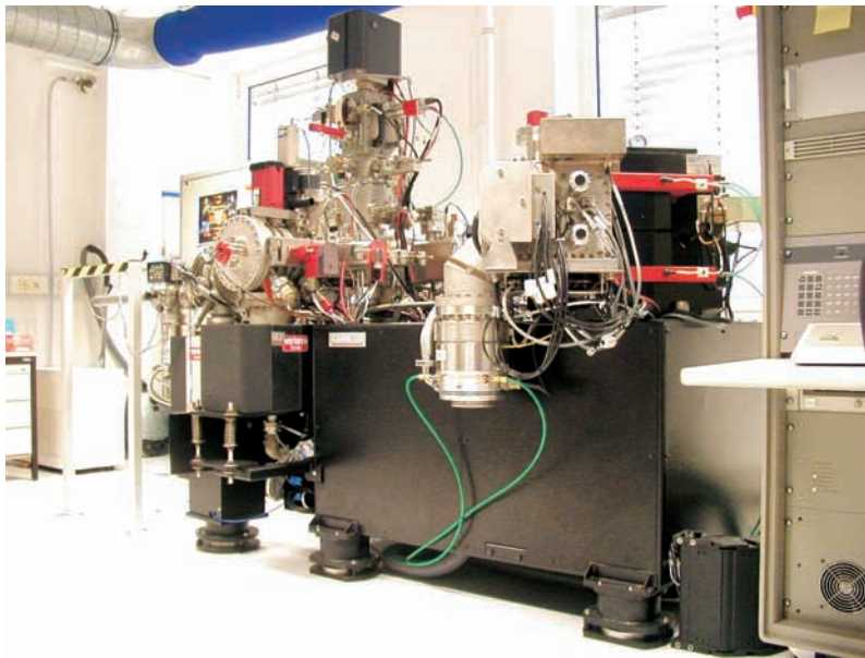
Abb. 1: NanoSIMS: Mit der NanoSIMS können Wissenschaftler feste Proben mit Größen von weniger als 100 Nanometer (Millionstel Millimeter) untersuchen und ein dreidimensionales Bild der Element- und Isotopenzusammensetzung gewinnen.
